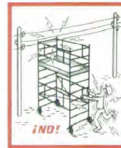
En el caso de trabajos en cercanías de líneas aéreas o de cables subterráneos bajo tensión, respetar las distancias de seguridad
