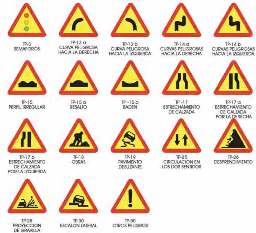
SEÑALES DE PELIGRO
